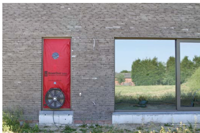
Fig. 7.1 Essai de pressurisation (à gauche) et détection des fuites d'air au moyen d'un fumigène (à droite).
