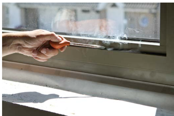
Fig. 7.1 Essai de pressurisation (à gauche) et détection des fuites d'air au moyen d'un fumigène (à droite).
