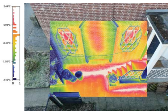
Fig. 7.2 La thermographie infrarouge permet de voir les zones mal isolées.
