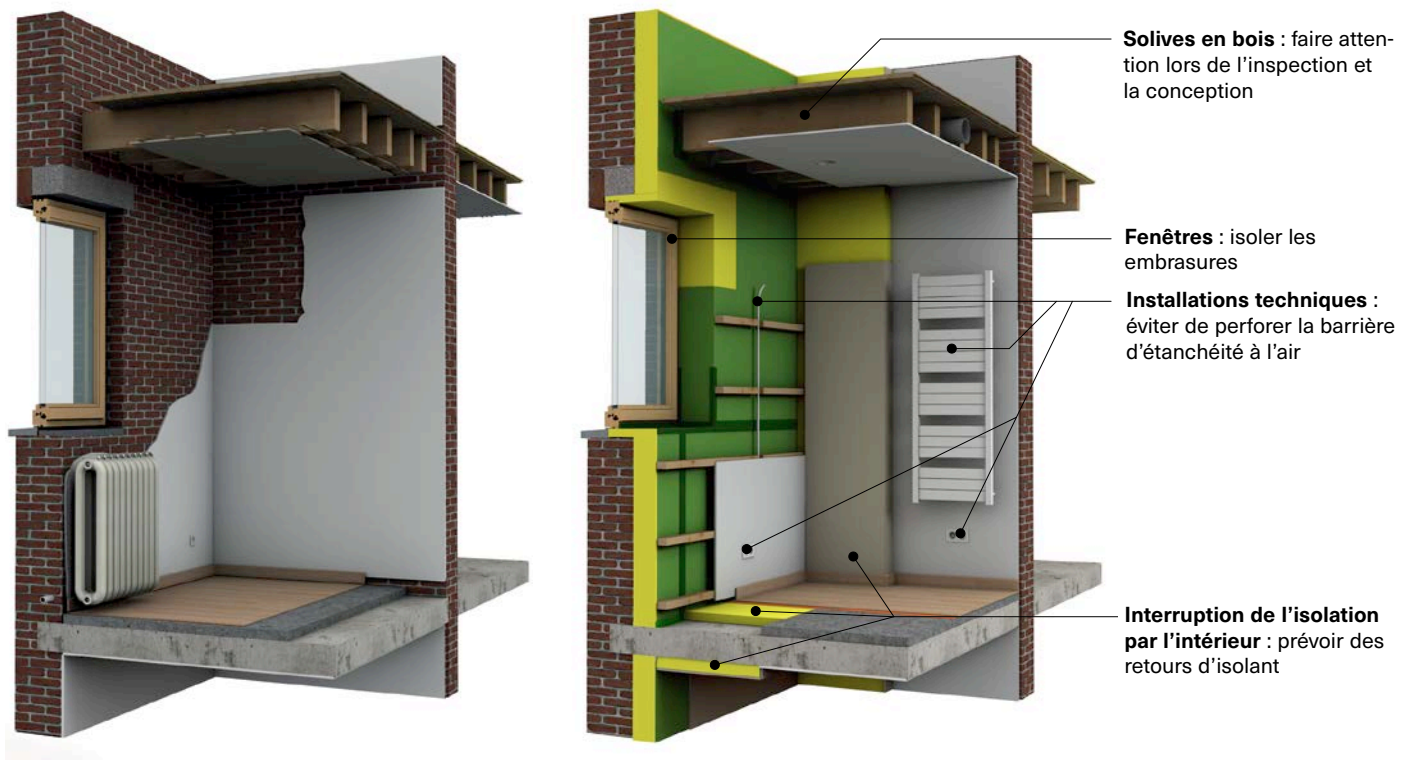
Fig. 6.13 Illustration de la situation avant et après les travaux de rénovation, avec mention des points importants.
